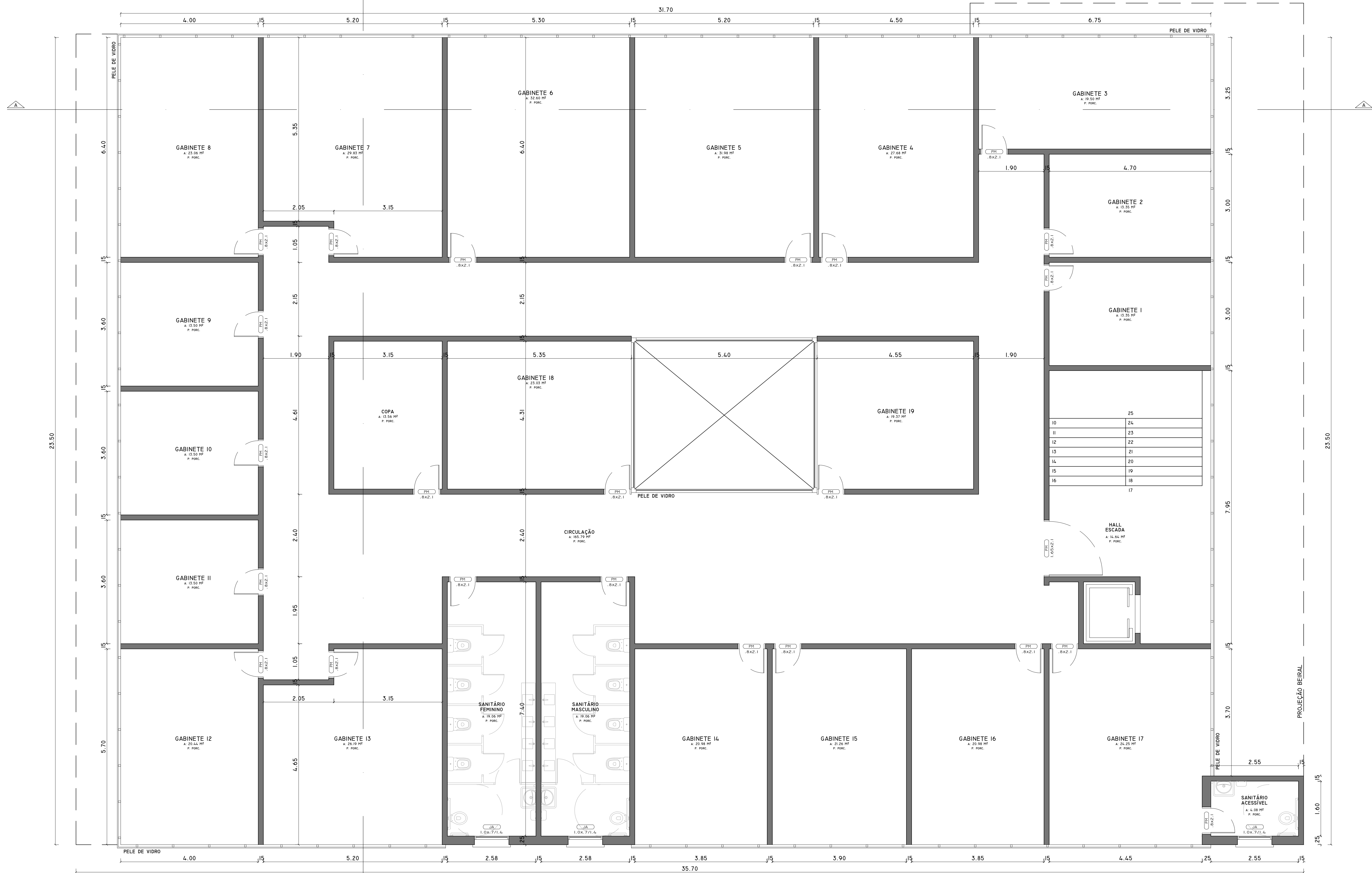
PLANTA BAIXA SEGUNDO PAV. ÁREA: 750.35 M² ESC. 1/50
